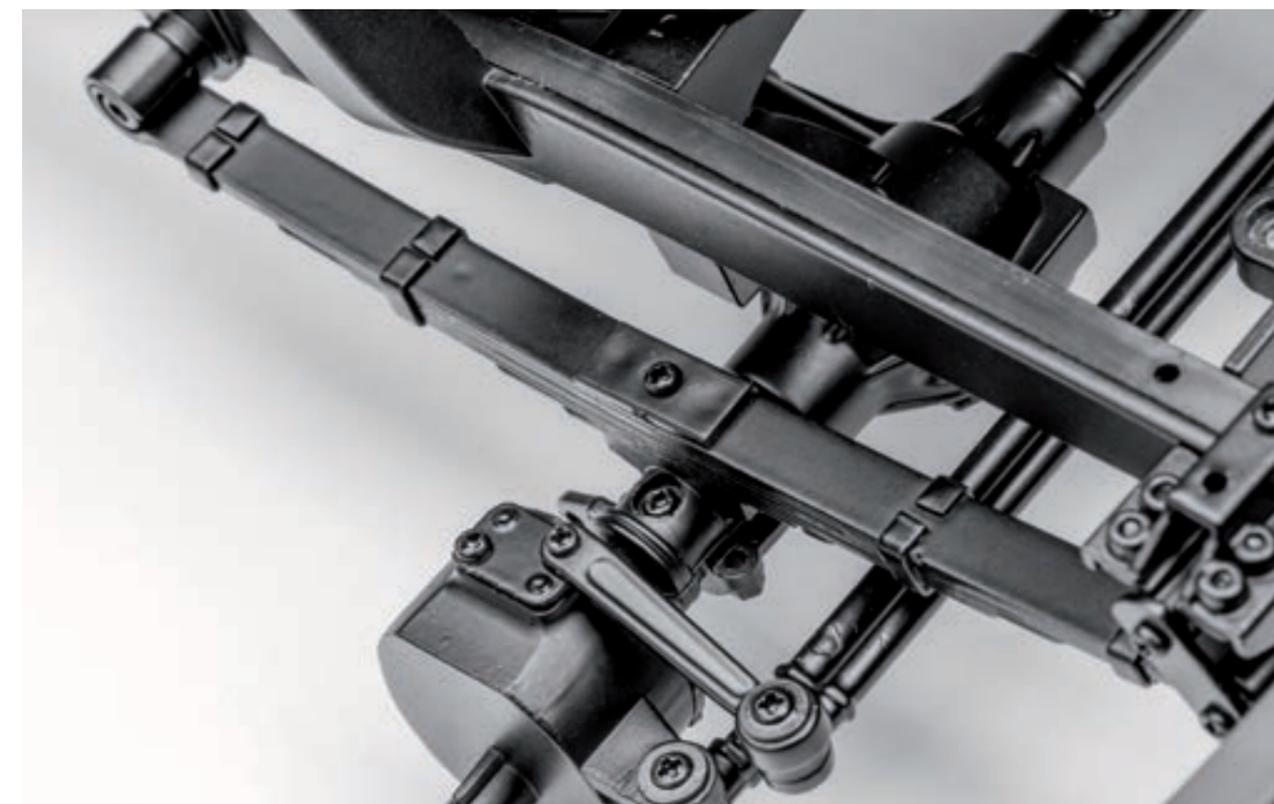
**Шаг 9.** При помощи винта 2,3×5 (IM) и специальной шайбы закрепите задний конец рессоры на оси кронштейна правого лонжерона рамы.
