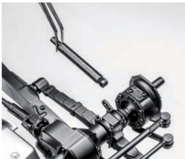
**Шаг 11.** При помощи винта 2,0×5 (НМ) закрепите корпус амортизатора на кронштейне кожуха правой полуоси переднего моста. Амортизатор крепится с внешней стороны кронштейна кожуха.
