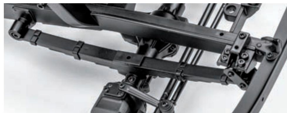
**Шаг 7.** Установите задний конец рессоры на ось заднего кронштейна рамы. Разместите опору передней кронштейна рессоры поверх правого лонжерона рамы модели. Закрепите опору на раме винтом 2,0×4 (EP).
