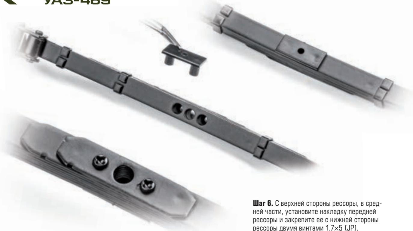
**Шаг 6.** С верхней стороны рессоры, в средней части, установите накладку передней рессоры и закрепите ее с нижней стороны рессоры двумя винтами 1,7×5 (JP).
