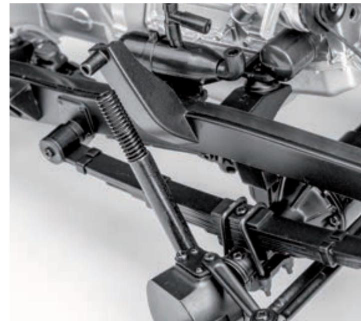
**Шаг 12.** Поверх штока амортизатора установите пружину и кожух амортизатора. Закрепите верхнюю часть кожуха амортизатора на кронштейне рамы винтом 2,3×4 (РМ).
