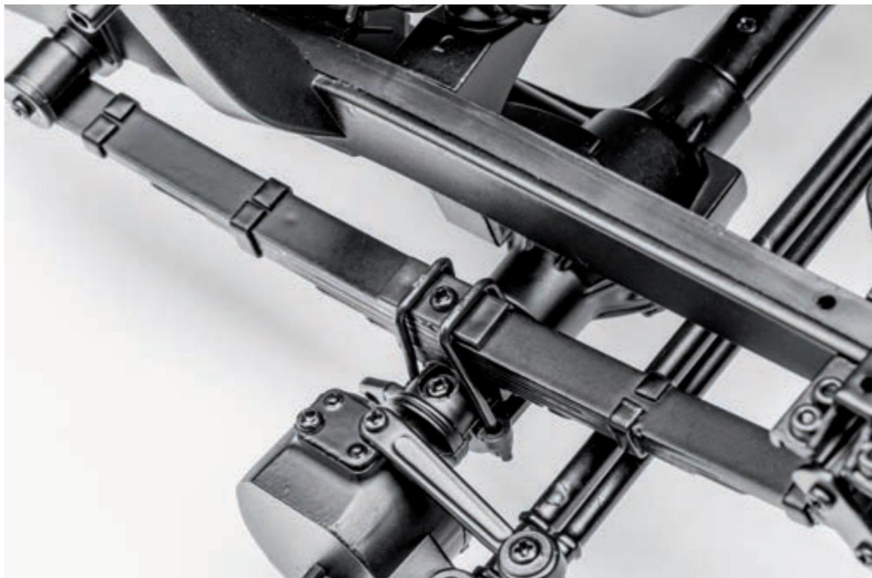
**Шаг 10.** Установите две стремянки поверх рессоры. После монтажа стремянки должны быть изогнуты к центру рессоры. Закрепите стремянки в площадке рессоры на кожухе полуоси. Стремянки должны держаться в отверстиях за счет трения. Для дополнительной фиксации воспользуйтесь клеем.
